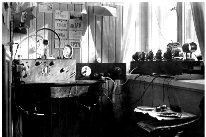
Kirres och Marjattas gemensamma radiostation från början av trettioalet. Mottagaren står på bordet och sändaren av öppen konstruktion i fönsternischen. Observera de märkbart stora rörspolarna av koppar. Bild från SRAL:s arkiv.
